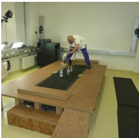
Messung der Reaktionskräfte auf dem viergeteilten Laufband der Tierärztlichen Hochschule Hannover.
