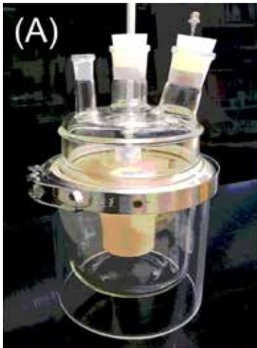
Abbildung 3: Das Endokarditis-Bioreaktormodell als pulsierendes Kreislaufmodell mit physiologischer Temperatur und In-vivo-Flussbedingungen. Die Herzklappen befinden sich zwischen Aorten- und Ventrikelkompartiment. Das Modell ermöglicht das Bakterienwachstum auf den Herzklappen und reproduziert vergleichbare Bedingungen für die Biofilmbildung in vivo.
